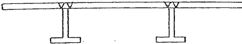
Para o desempenar termos de provar o efeito de quinadeira dando calores, na face da chapa oposta ao perfil e ao longo da direcção de cada uma das soldaduras. O efeito de quinadeira provocando com aplicação de calores eliminará o efeito originado pelo calor da soldadura e a chapa volta à posição correcta sem empeno.
